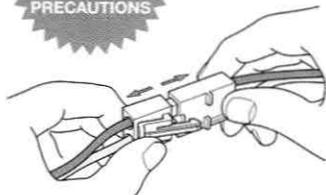
走行させない時は必ず走行用バッテリーのコネクターをはずしてください。走行用バッテリーをつないだままでおくと、車が暴走することがあります。走らせないときは、必ず走行用バッテリーのコネクターを抜いておきます。
