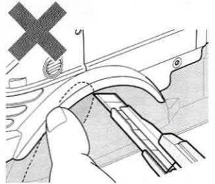
★カッターナイフで切り取る場合は、一度に切らずに数回にわけて浅く切り込みを入れ、切れ目によって折り曲げるようにして切りはなしてください。
